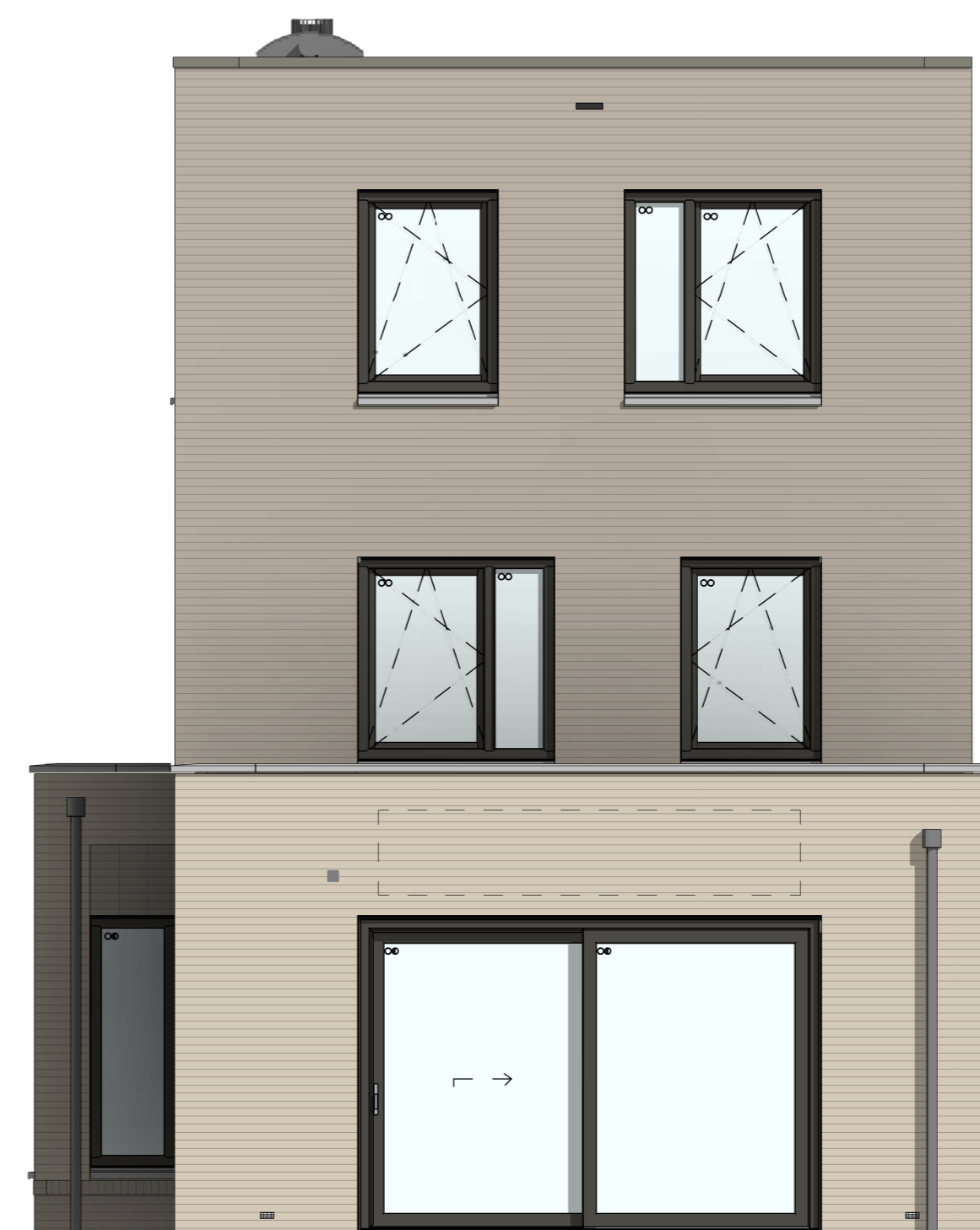
C-AB6024-a- Aanbouw achtergevel, 2400mm, incl. verhoogde dakrand C-AG5004 - Achtergevel voorzien van schuifpui C-LS6024 - Lichtstraat lengte circa 3.300mm x 1.000mm in achteruitbouw (alleen mogelijk i.c.m. optie AB6024-a)
